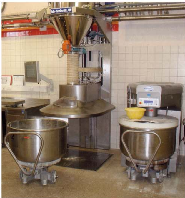
Links: Diosna Wendelkneter. Rechts: HEUFT Thermoöfen mit Thermoroll Steinplatten
