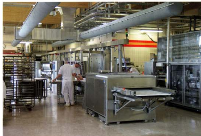
Die Form des Gebäudes folgt seiner Funktion. Das hat dazu geführt, dass Linauer beispielsweise die Teigmacherei mit einer niedrigen Raumhöhe gebaut hat, um möglichst wenig Luft zu klimatisieren.
